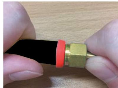
3. Inserire il tubo fino a battuta all'interno del cappuccio plastico.
